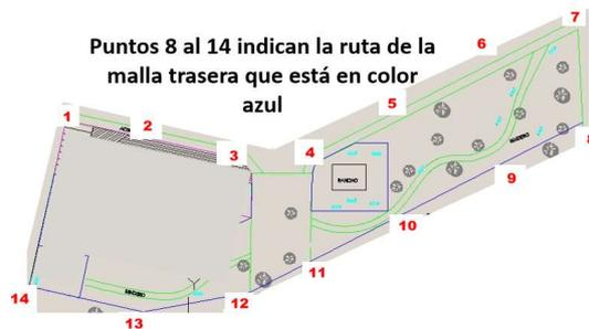
La malla será “tipo Zumbado”, con recubrimiento plástico color verde, de 2.5 metros de altura sobre el nivel del terreno. Cada poste deberá tener una tapa bien sellada para evitar que ingrese el agua. Cada poste debe ir cimentado en una estructura de concreto con una resistencia mínima de 210 kg/cm<sup>2</sup>. La profundidad de cada base de concreto y sus dimensiones serán acorde al diseño estructural que debe realizar el contratista. Los cimientos serán colocados sobre terreno firme.
