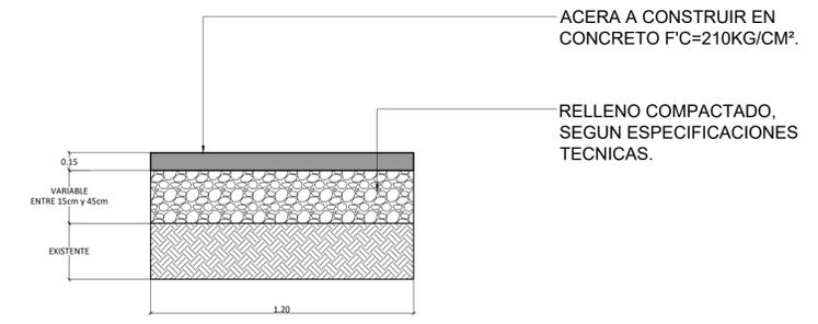
DETALLE PARA ACERA/LOSA DE CONCRETO
